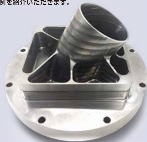
三菱重工工作機械(株)様提供 Ti6Al4Vダクト(造形品)
